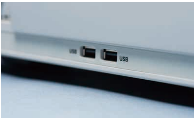
USB 端口位于前部和后部，用于下载常数和远程 PC 通信。
