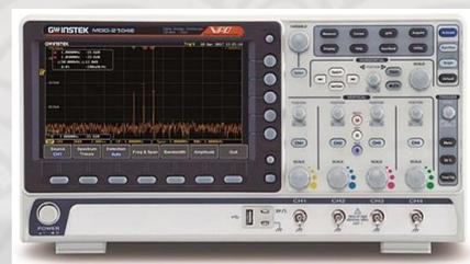
I<sup>2</sup>C/SPI/UART/CAN/LIN 串行总线触发和解码功能。
